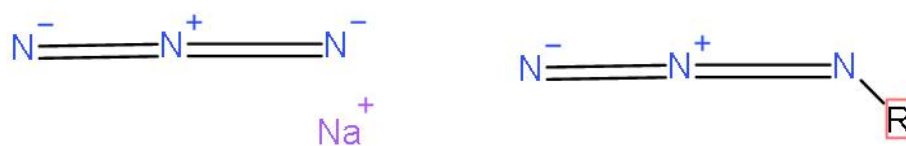
图1 叠氮酸钠与叠氮基结构式
